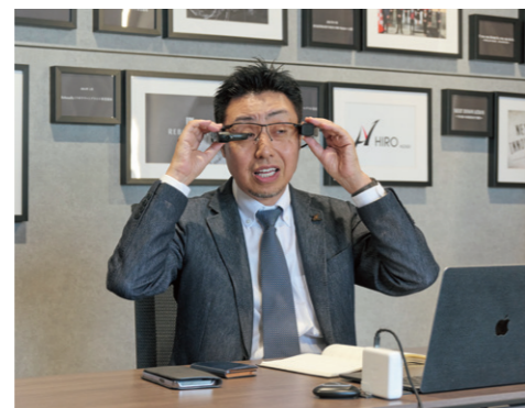
スマートグラスは、作業者に装着させることで、遠隔地から指導、指示ができるウェアラブルデバイス
